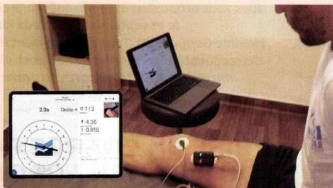
Photo 2 : Utilisation du capteur Kmyo pour tester la coactivation du quadriceps et des ischio-jambiers.
